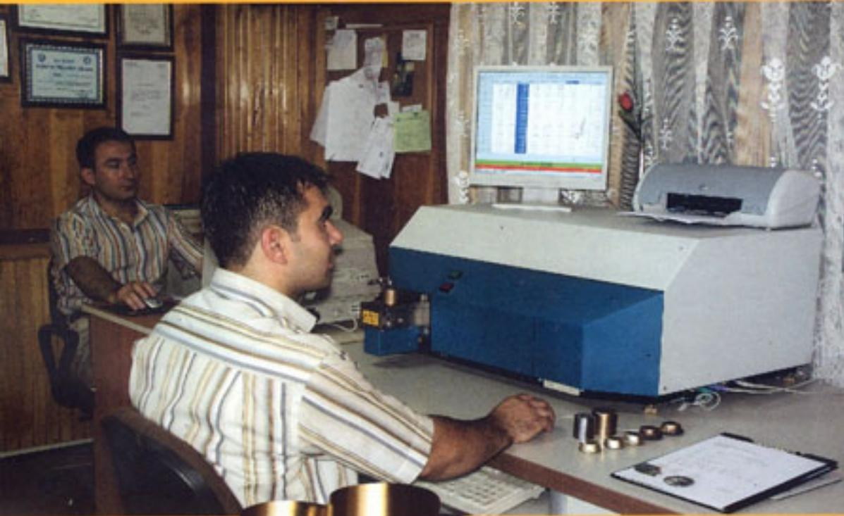
Alkor bünyesinde bulunan laboratuvarda spektrometre kimyasal analiz cihazı ile ergitilen malzemenin analizini dökümden önce kontrol ederek döküm yapılmaktadır.
